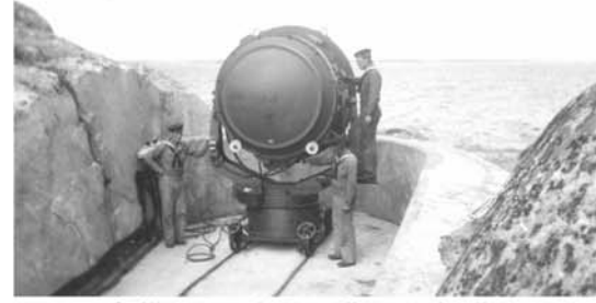
Strålkastare med 150 cm diameter på tralla. Radarn var ännu inte uppfunnen. /Krigsarkivet
